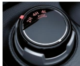
Система приводу EASY SELECT PART TIME 4WD
